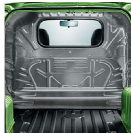
Stała przegroda z centralnie umiejscowioną szybą oddziela kabinę od przedziału ładunkowego (w wersjach Elegant).
