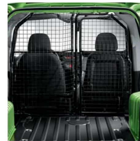
Uchylna, dwuczęściowa przegroda: część stała po stronie kierowcy, składana – od strony pasażera.
